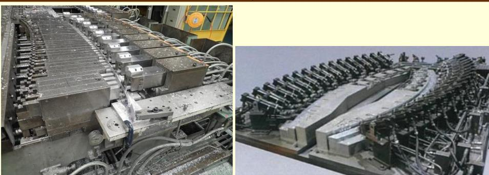
**[目標]** ③3次元油空圧配管構造を内蔵する従来比2分の1(重量)の小型/軽量/省資源/自動化ジグ(モデル)の実現
