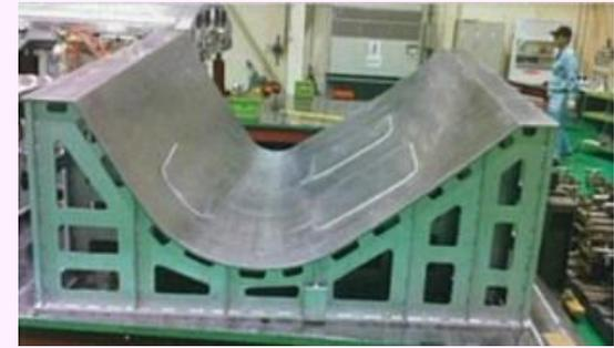
**[目標]** ④航空機CFRP部品用金型製造に向けた空気が漏れないインバー材の3Dプリンティング
