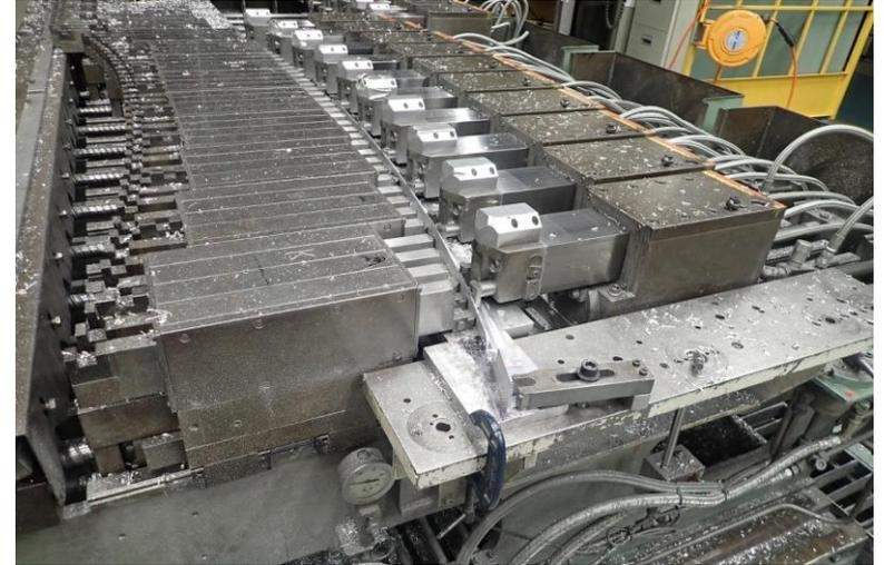
航空機フレーム製造用アルミ製ジグの例
