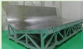
空気漏れのないインバー材3D造形物作製
