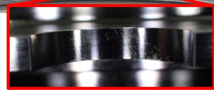
← 本技術実用化前の実部品加工結果 (耐熱合金製)
