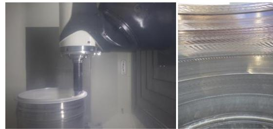
(MHIAEL\*1でのNi基エンジンケースの加工例) \*1 三菱重工航空エンジン
